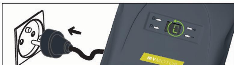
Mettre l'opérateur sous tension 220 Volt : la lumière de courtoisie s'allume, l'opérateur sonne une fois et l'indicateur signale un «0» tournant.
