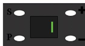
Appuyer sur «+», un «1» clignote indiquant que la fonction est active. La fermeture automatique est calée à 30 sec.
